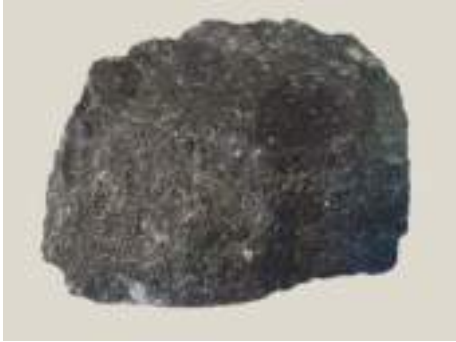
Андезити мають характерну відмінність — порфірову структуру з великими світлими кристалами плагіоклазу у зелено-сірій загальній масі породи. Зразок з колекції О. Митрохина (фото І. Парнікози)
