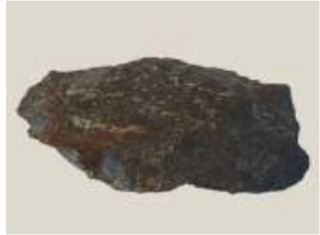
Ігнімбрит — вулканічна уламкова гірська порода, яка має ознаки як лав, так і пірокластичних утворень, уламкову будову переважно з дрібних частинок вулканічного скла, пемзи і кристалів. Зразок з колекції О. Митрохина. Острів Галіндез (фото І. Парнікози)
