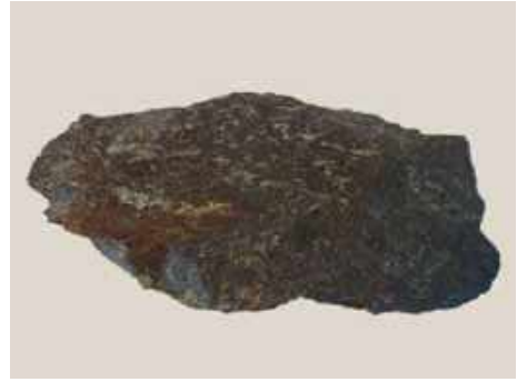
Ігнімбрит — вулканічна уламкова гірська порода, яка має ознаки як лав, так і пірокластичних утворень, уламкову будову переважно з дрібних частинок вулканічного скла, пемзи і кристалів. Зразок з колекції О. Митрохіна. Острів Галіндез (фото І. Парнікози)
